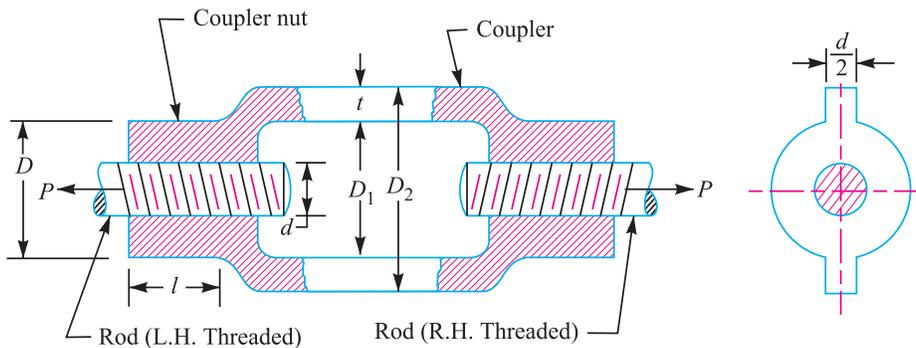
Fig. 12.19. Turnbuckle.
