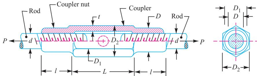
Fig. 12.18. Turnbuckle.
